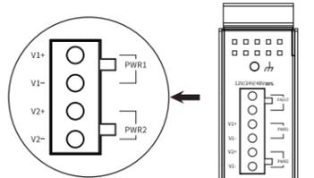
1. 将负/正DC线插入接线端子的V-/V+端子。
