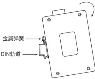
2. 将DIN导轨座单元迅速按入如下图所示位置。
