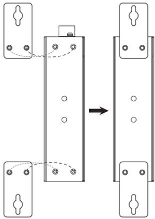
3. 将光纤收发器壁挂安装在墙上需要2个螺钉。螺钉的头部直径应小于6毫米，轴的直径应小于3.5毫米，如下图所示。使用安装好壁挂件的交换机，标记2个螺钉的正确位置。
