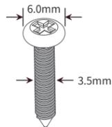
4. 在固定螺钉到墙体之前，请通过将螺钉插入壁挂件的一个锁孔中，确保螺钉头和柄的尺寸合适。固定螺钉到墙体时，不要将螺钉完全拧进去，需留出2毫米左右的空间，以便在墙体和螺钉之间滑动壁安装面板。
